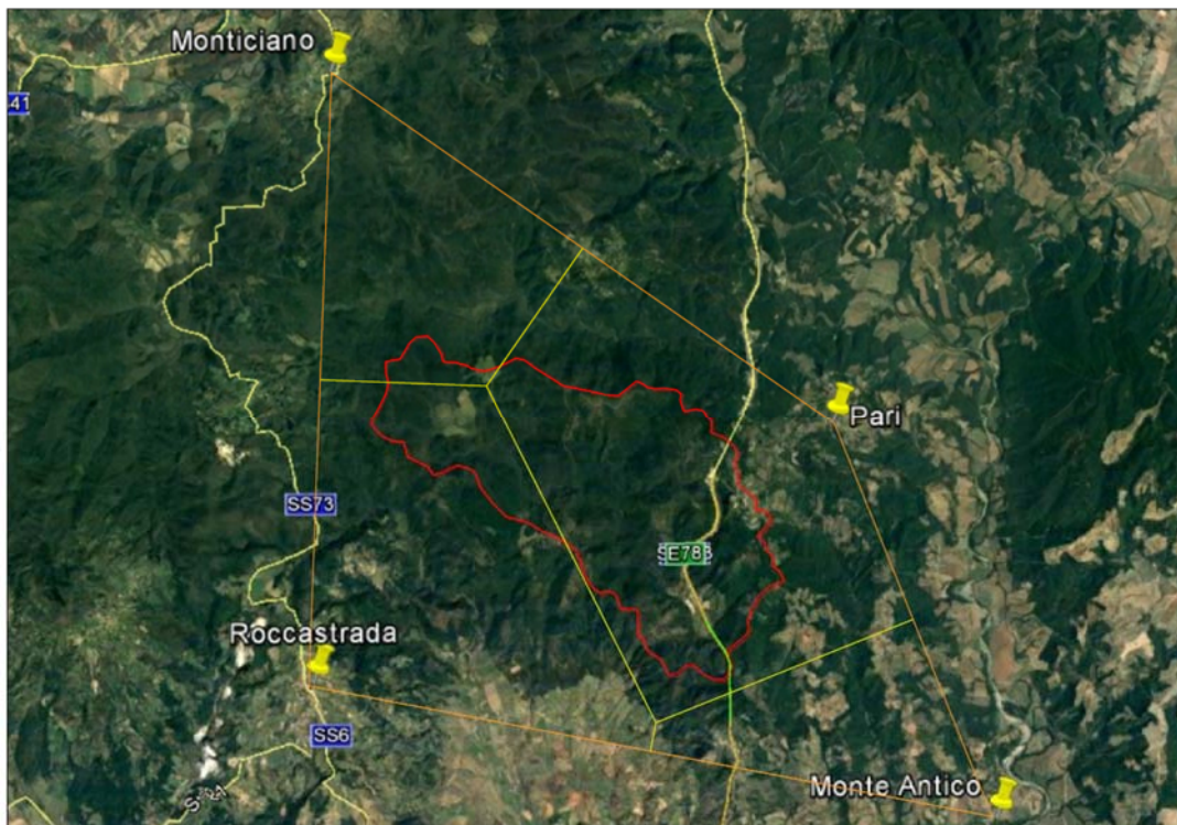
Fig. 4.2.3. Rappresentazione dei poligoni di Thiessen per il bacino del Torrente Lanzo in rosso, e per l'asse stradale in verde.
