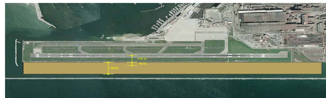
Figura 3-6 Il riempimento in affiancamento all'Aeroporto
