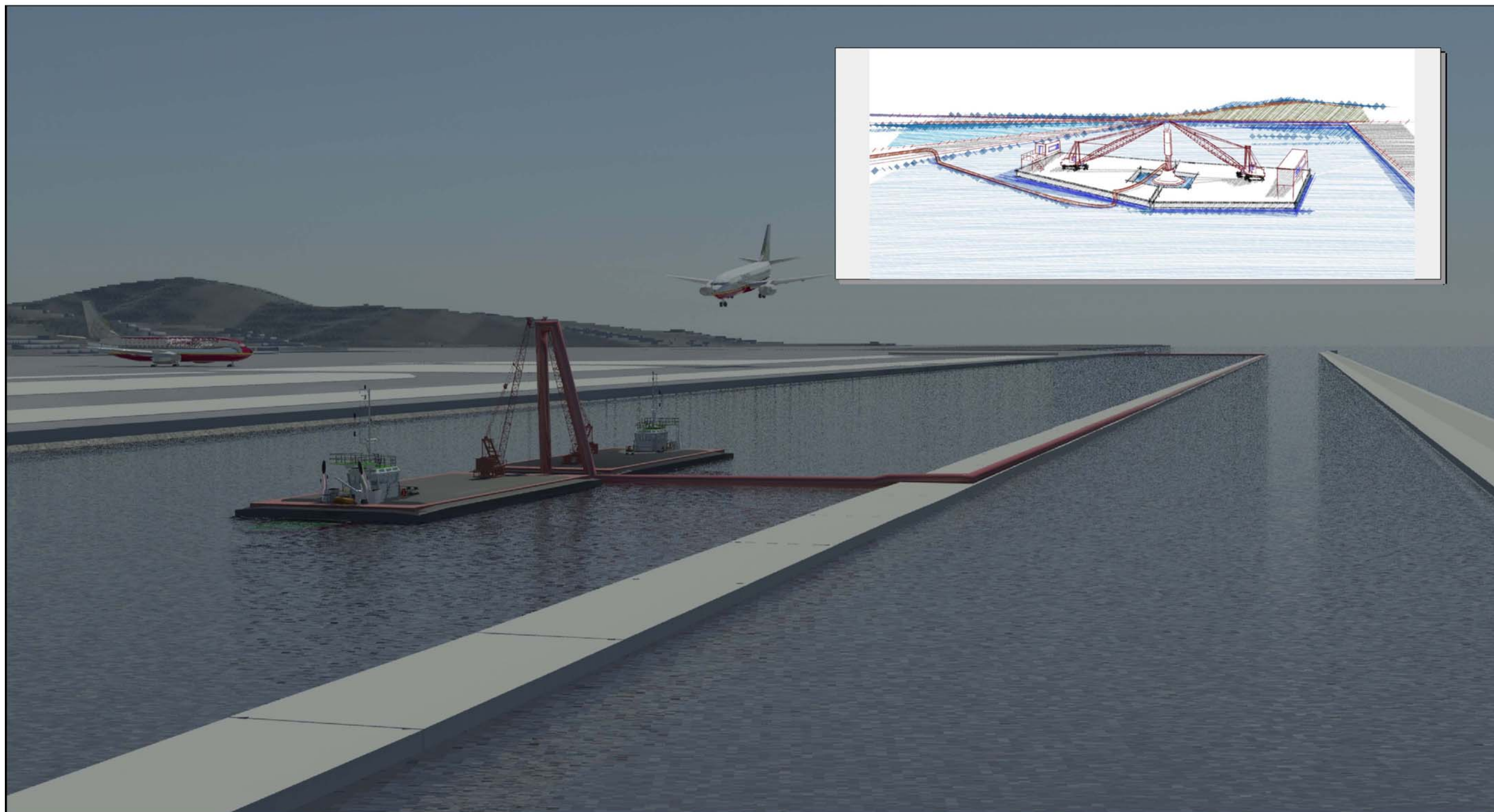
Figura 5-28 Versamento dello slurry all'interno della colmata - Schema del versamento
