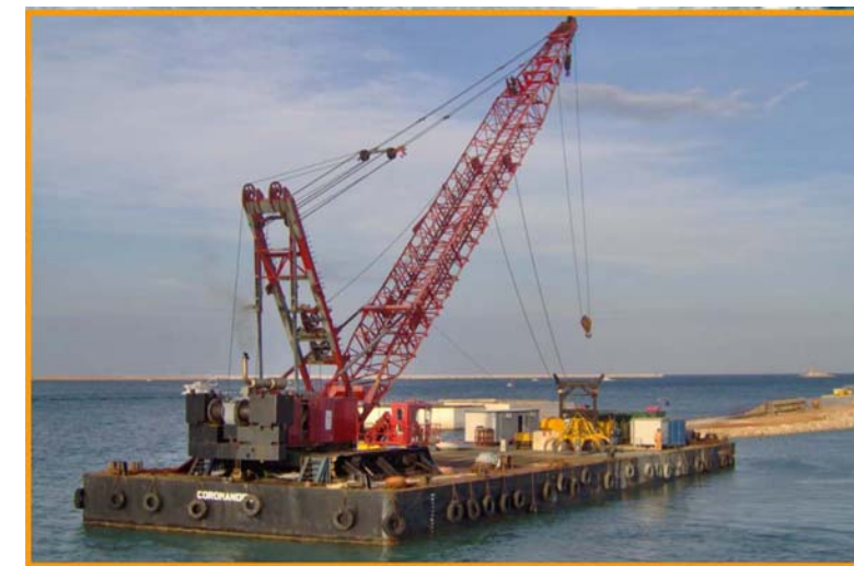
Figura 5-16 Pontone tipo utilizzato per le lavorazioni più pesanti – Immagine
