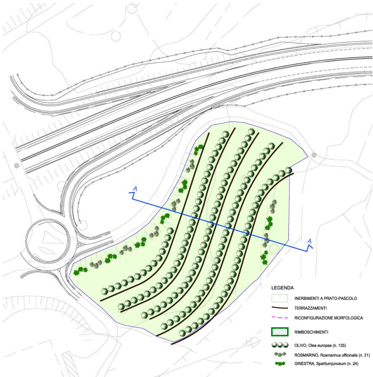
Figura 28: Area di Cantiere 1 – Planimetria della riambientazione
