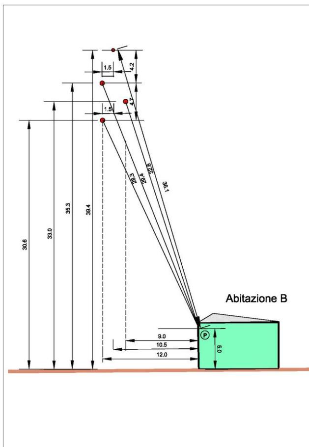
Con riferimento a quanto detto al punto 6.1 si è preso a riferimento la seguente disposizione delle fasi sui sostegni P3 e 823/3 con interasse linee di 45 m in corrispondenza dell'abitazione B:
