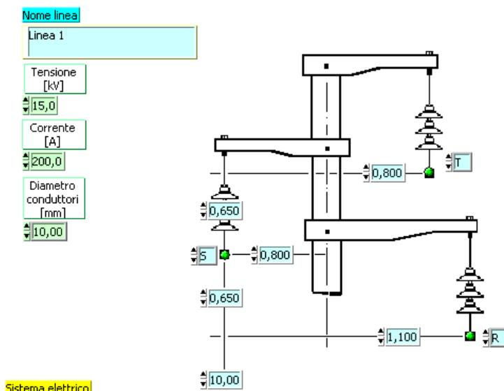
Caratteristiche elettriche e geometriche sostegno MT
