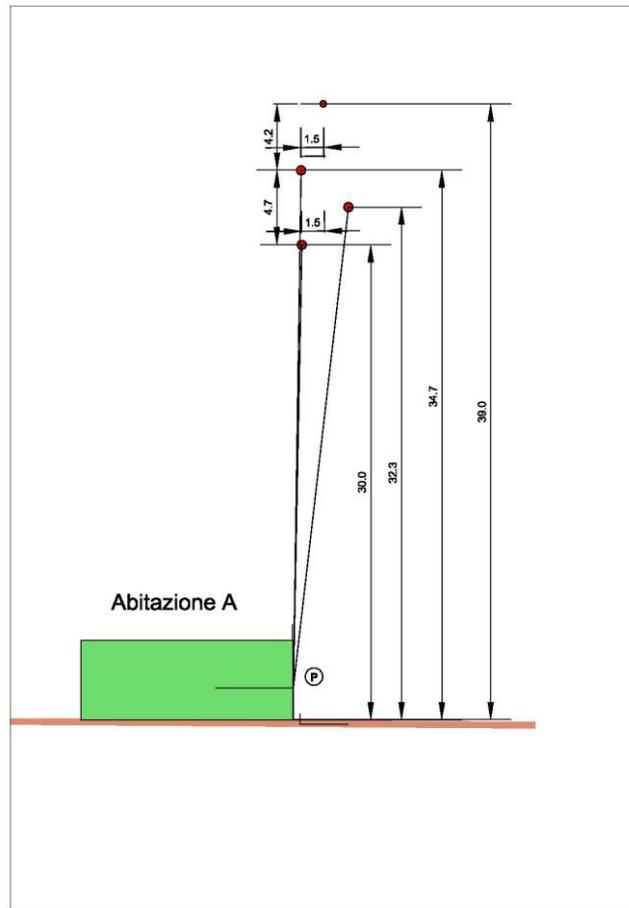
In conseguenza di quanto detto per il calcolo puntuale si è preso a riferimento la seguente disposizione delle fasi sui sostegni P3 e 823/3 con interasse linee di 38 m in corrispondenza dell'abitazione A.
