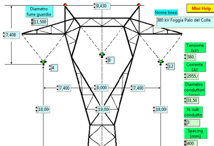
Caratteristiche elettriche e geometriche elettrodotto 380 kV
