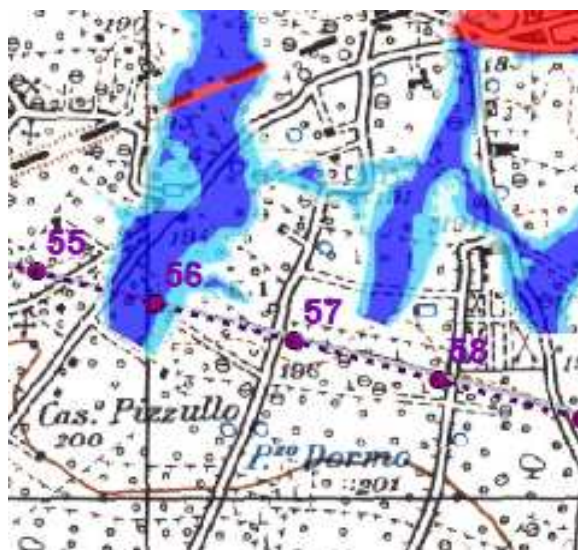
Figura 5: Stralcio pericolosità idraulica elettrodotto esistente Sostegno 56
