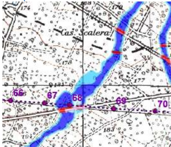
Figura 6: Stralcio pericolosità idraulica elettrodotto esistente Sostegno 68
