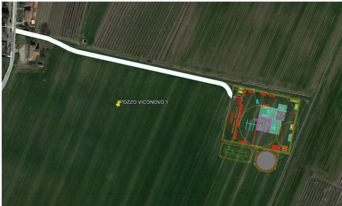
Figura 3.3 - Strada di accesso alla postazione da realizzare (tracciata in bianco). Il pin giallo - Pozzo Viconovo 1 dir - indica la posizione del fondo pozzo.
