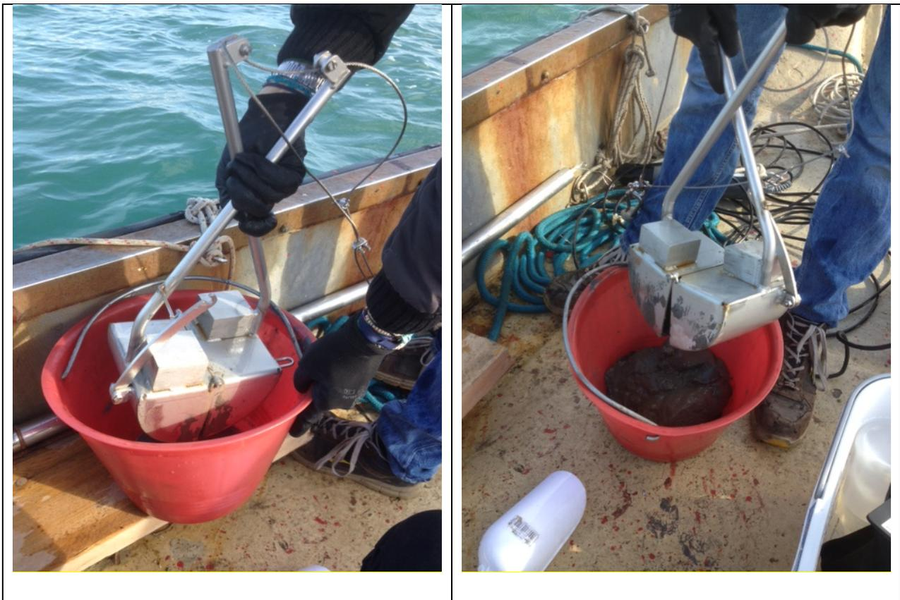
Foto 6. benna di Van Veen utilizzata per il campionamento dei sedimenti
