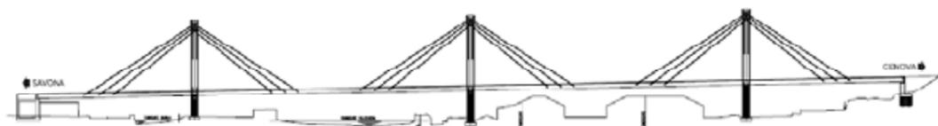
Figura 10-35 Sezione longitudinale del nuovo Viadotto "Genova"
