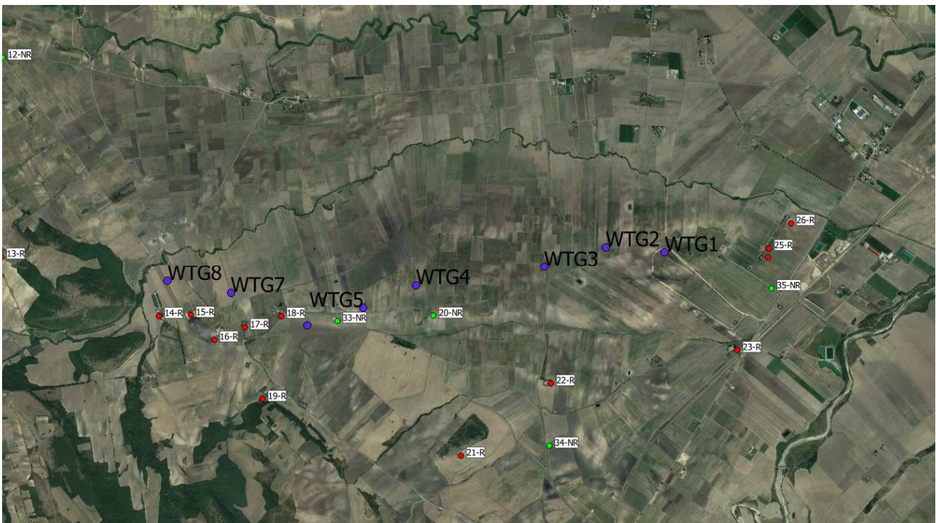
Layout impianto su ortofoto (in viola le WTG, in rosso gli EDIFICI CONSIDERATI RICETTORI)
