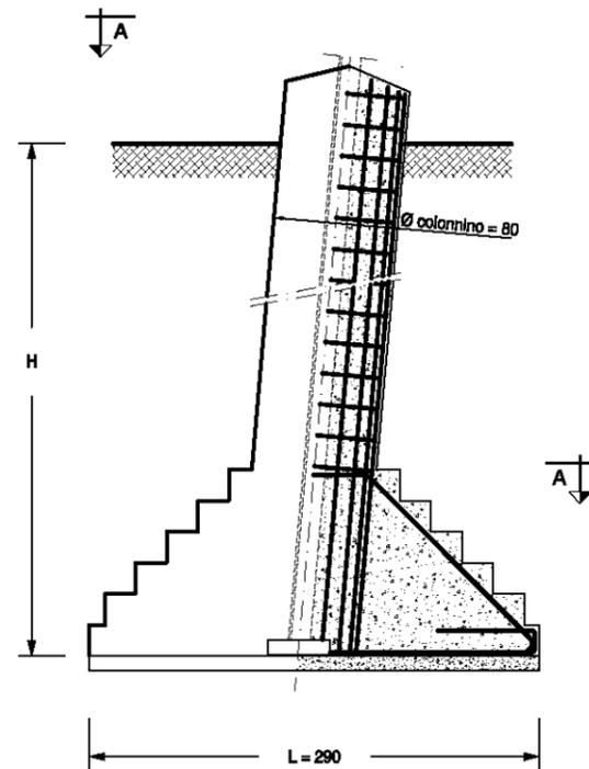
PIANTA - SEZIONE A-A PLINTO FONDAZIONE
