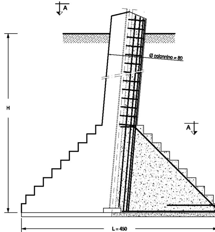
**PIANTA - SEZIONE A-A PLINTO FONDAZIONE**
