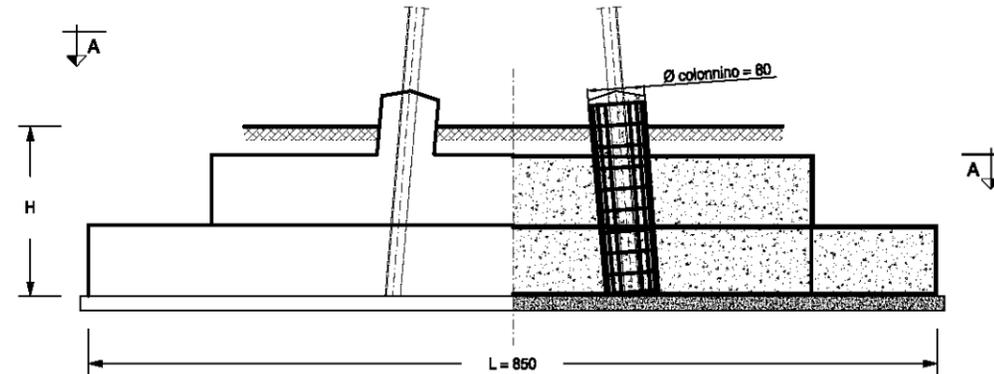
PIANTA - SEZIONE A-A PLINTO FONDAZIONE
