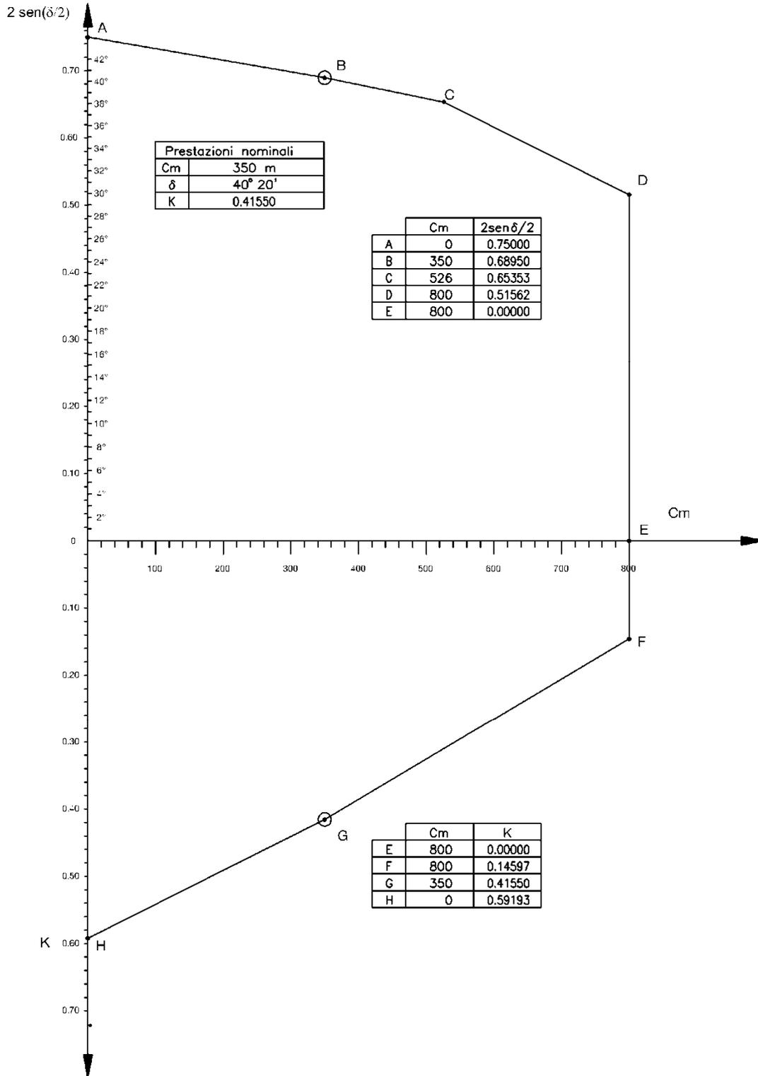
**DIAGRAMMA DI UTILIZZAZIONE DEL SOSTEGNO IN CORRISPONDENZA DI PRESTAZIONI VERTICALI PARTICOLARMENTE ELEVATE**
