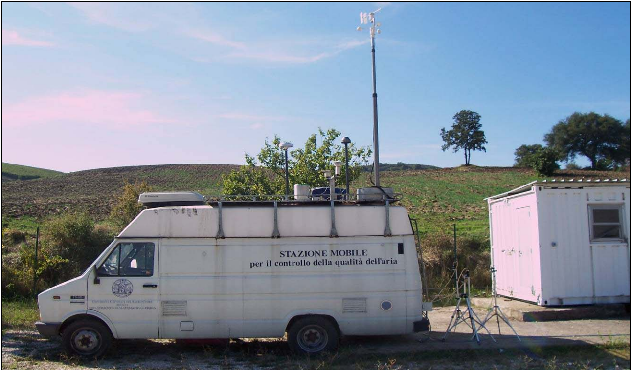
Fig. 4.2/2 – Laboratorio mobile utilizzato per il rilievo dei dati meteorologici e di qualità dell'aria
