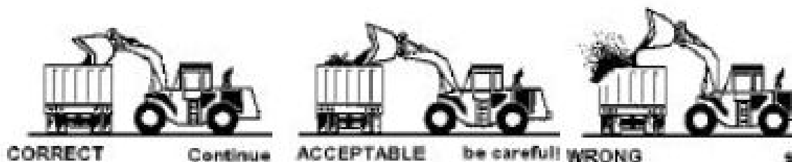
Figura 5 – Corrette procedure per il carico dei camion
