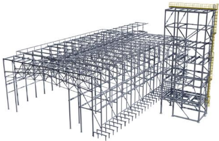
Figura 12: Strutture vano motori e camini
