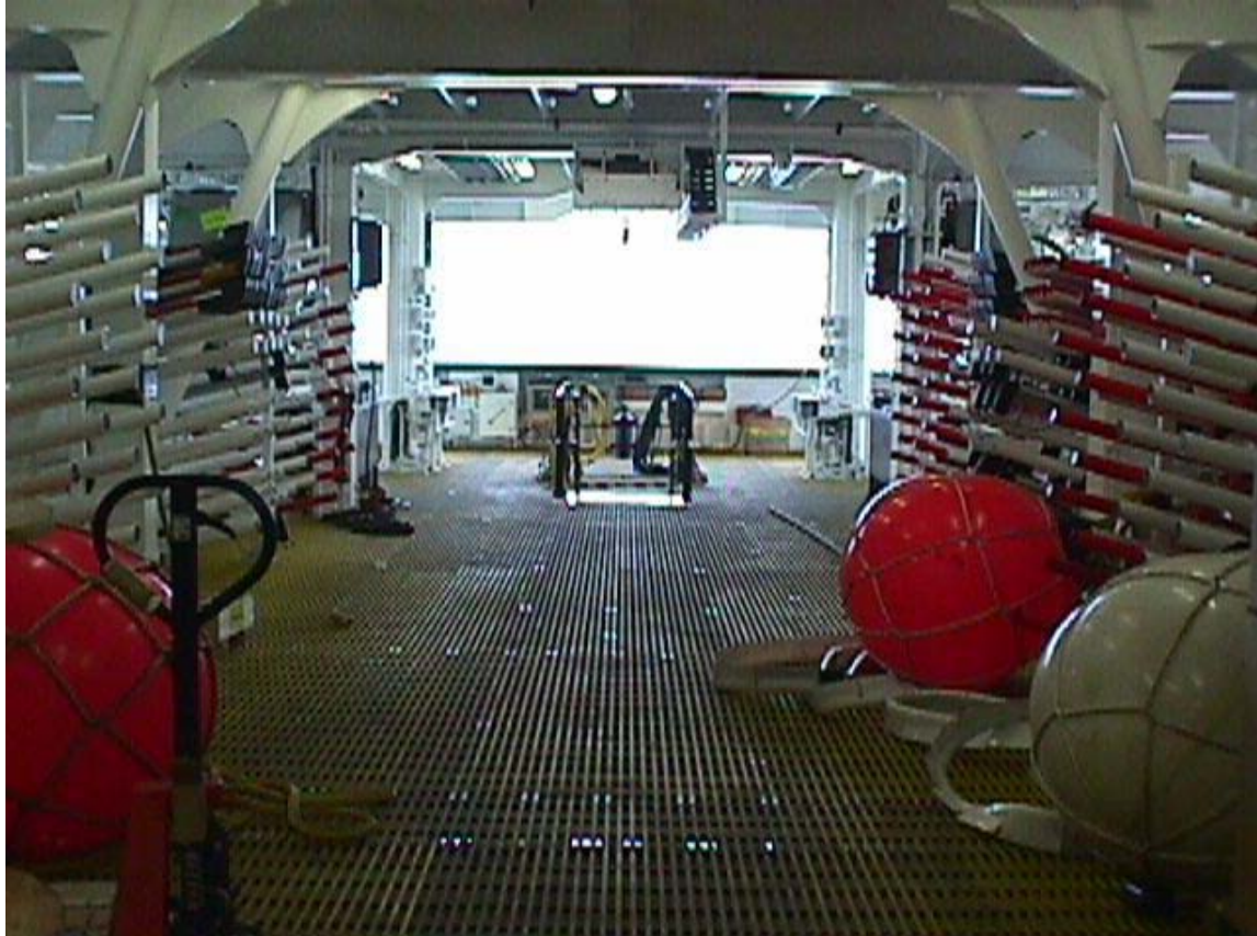
Figura 1-13: poppa di una nave per ricerca geofisica con gli stabilizzatori di profondità e le boe (Fonte: eni S.p.A. upstream & technical services)
