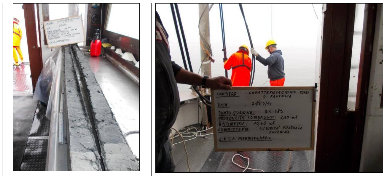
Figura 2 – Documentazione fotografica “tipo” del sondaggio eseguito.
