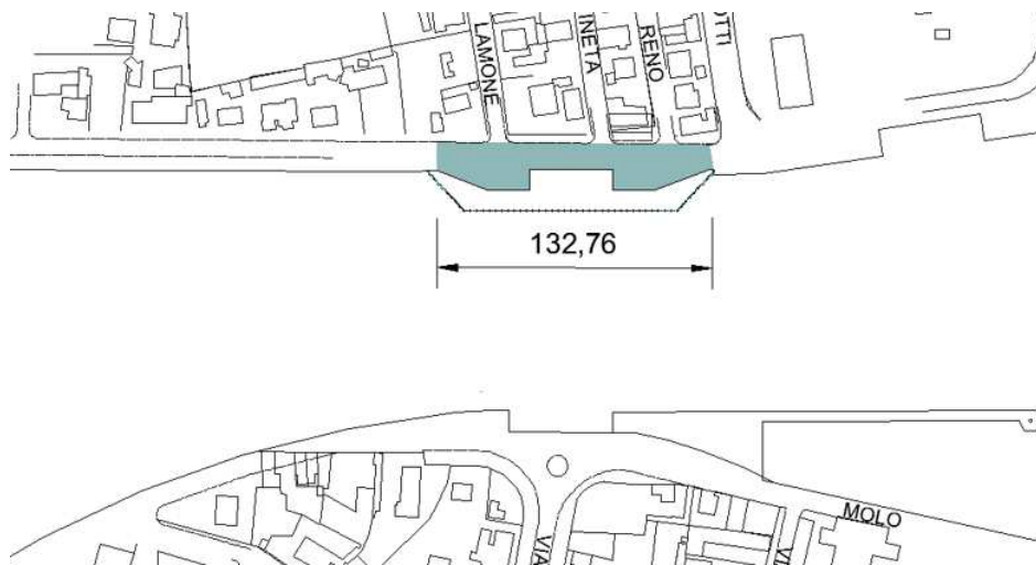
Figura 1 – Stralcio planimetrico dell’area di interesse con l’indicazione della banchina da proteggere (in celeste) e del tracciato del palancolato a protezione
