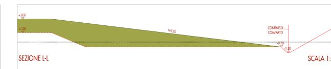
0 10 20 30 40 50 60 70 80 90 100 REALIZZAZIONE RILEVATI CLASSIFICAZIONE DELLE AREE PER RIPORTO TERRENI - SEZIONI TIPO
