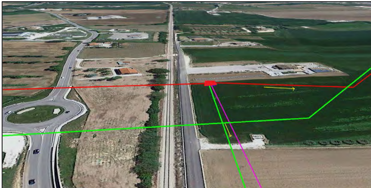
Foto A6: PIDI n. 4 in progetto (C.se Moroni) - in viola il rifacimento a Top Fondi Spa di Montecosaro e in blu e verde le linee da dismettere -
