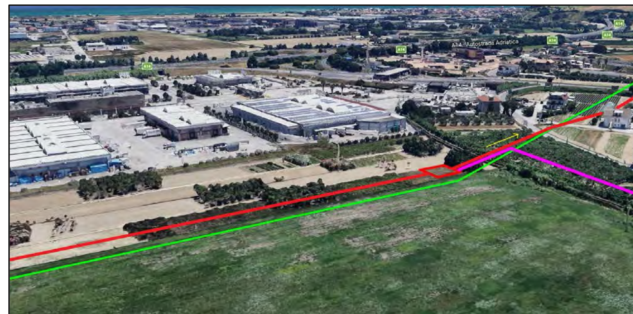
Foto A25: PIDI n. 13 in progetto (Contrada Isola) - in viola il nuovo collegamento per la derivazione per Ascoli Piceno 1° tratto e in verde la linea da dismettere -
