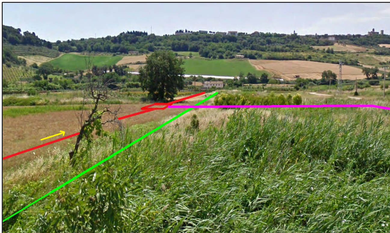
Foto A15: PIDI n. 8 in progetto (punto di attraversamento con S.S. 433 Val d'Aso) - in viola collegamento al Comune di Campofilone e in verde la linea da dismettere -
