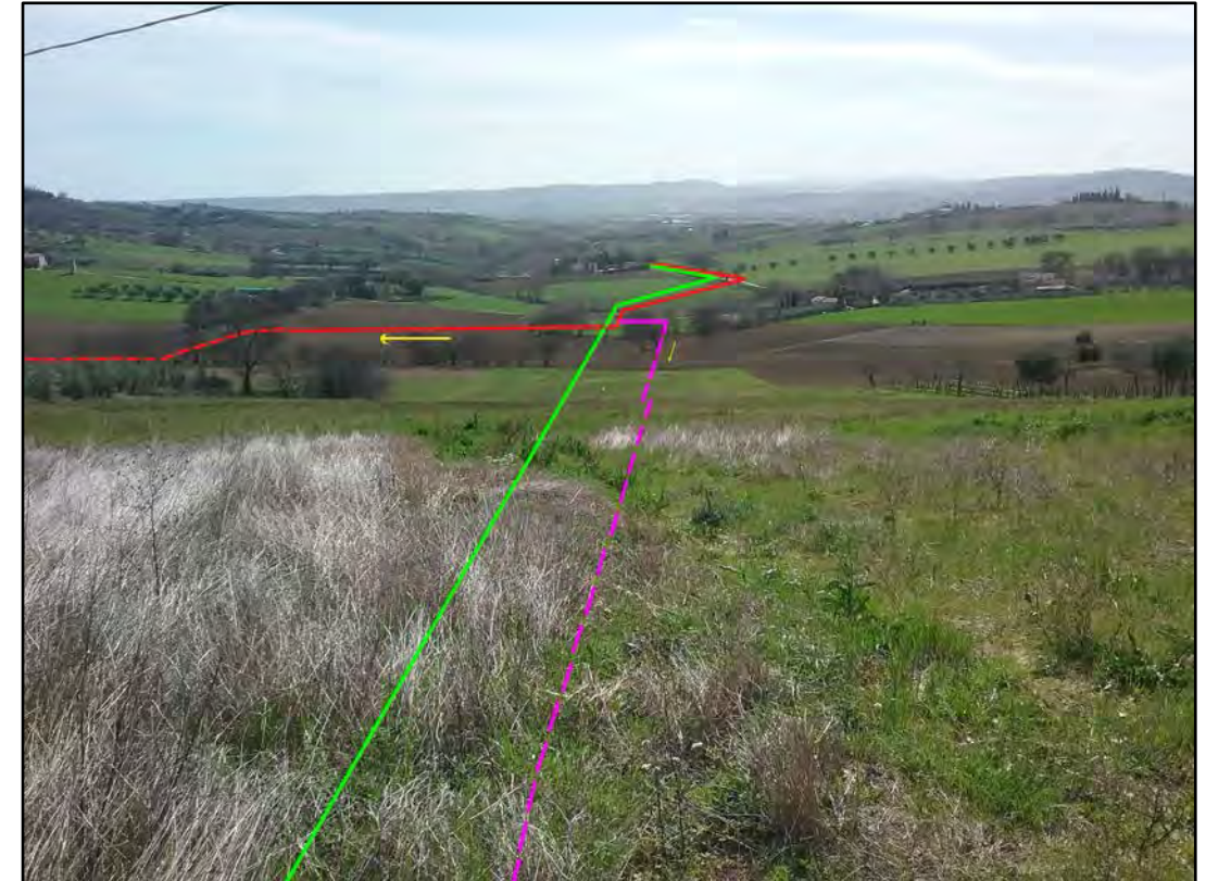
Foto 59: Coll. Comune di Morrovalle DN 100 (4''), DP 75 bar. Percorrenza in parallelo alla linea principale da dismettere - in rosso la linea principale in progetto -
