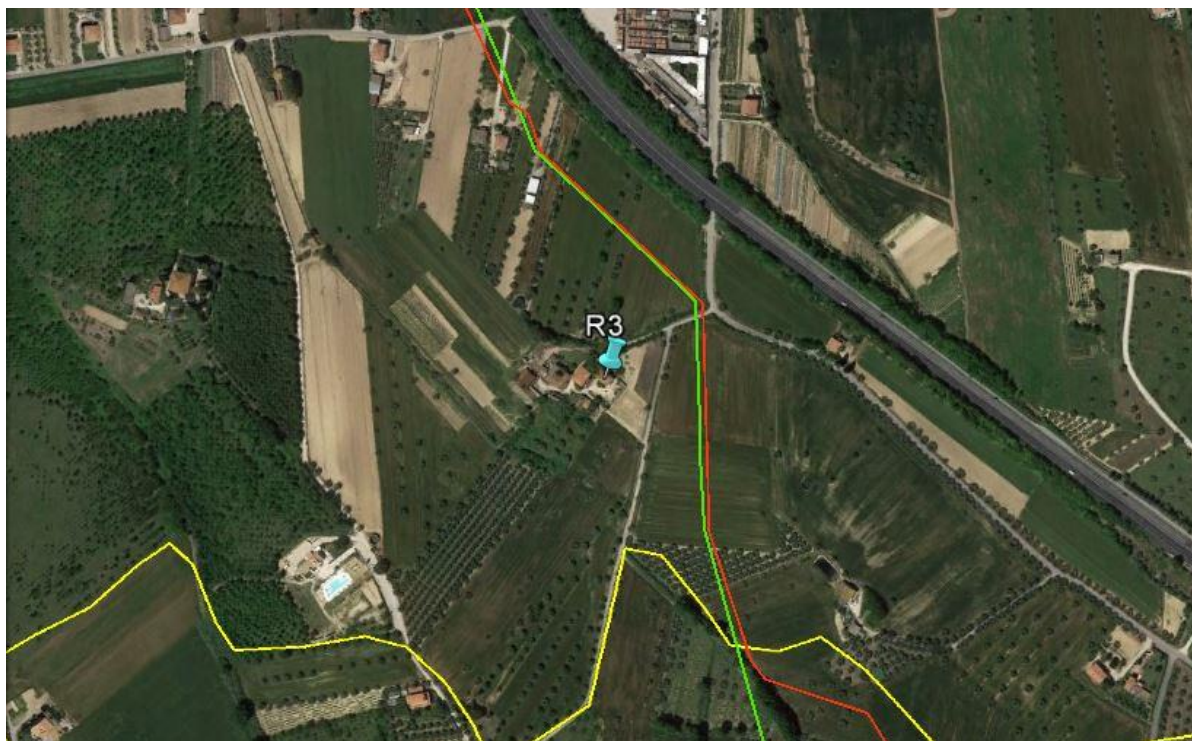
Figura 3/C: Immagine satellitare del punto R3. ■ = tracciato in progetto, ■ = tracciato in dismissione, ■ = confine comunale
