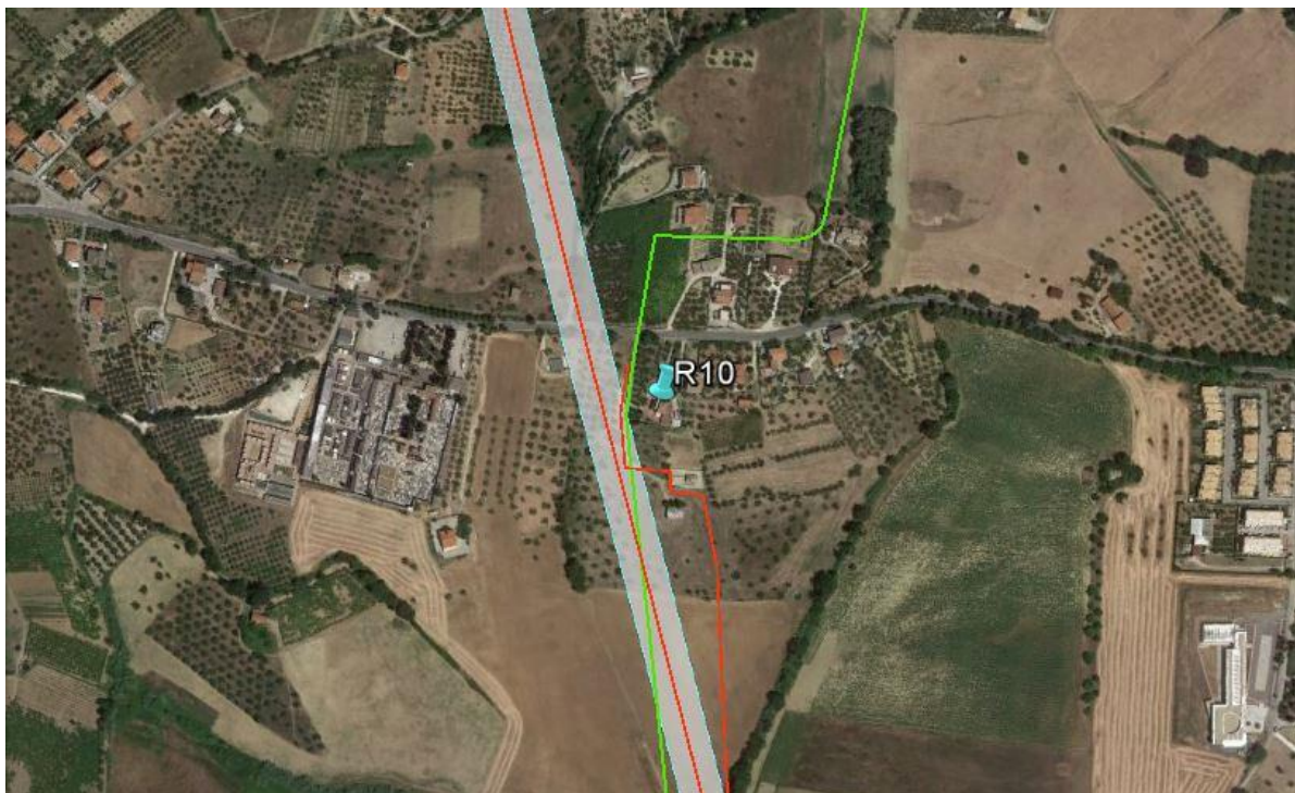
Figura 3/L: Immagine satellitare del punto R10. ■ = tracciato in progetto, ■ = tracciato in dismissione, ■ = microtunnel
