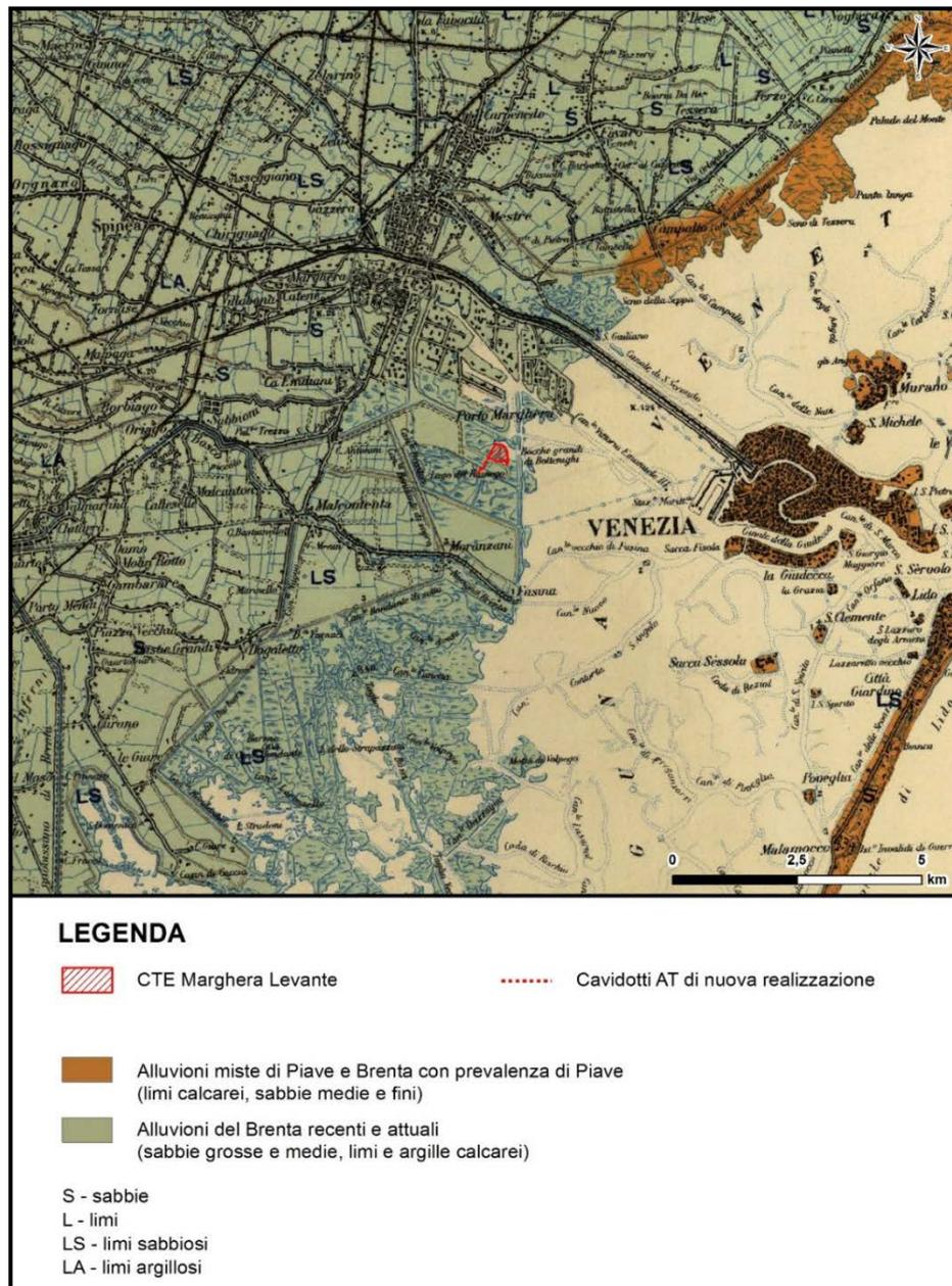
Come mostrato in figura, l'area interessata dagli interventi in progetto e una vasta porzione di territorio retro lagunare sono caratterizzate dalla presenza di depositi alluvionali, di natura da sabbiosa ad argillosa.
