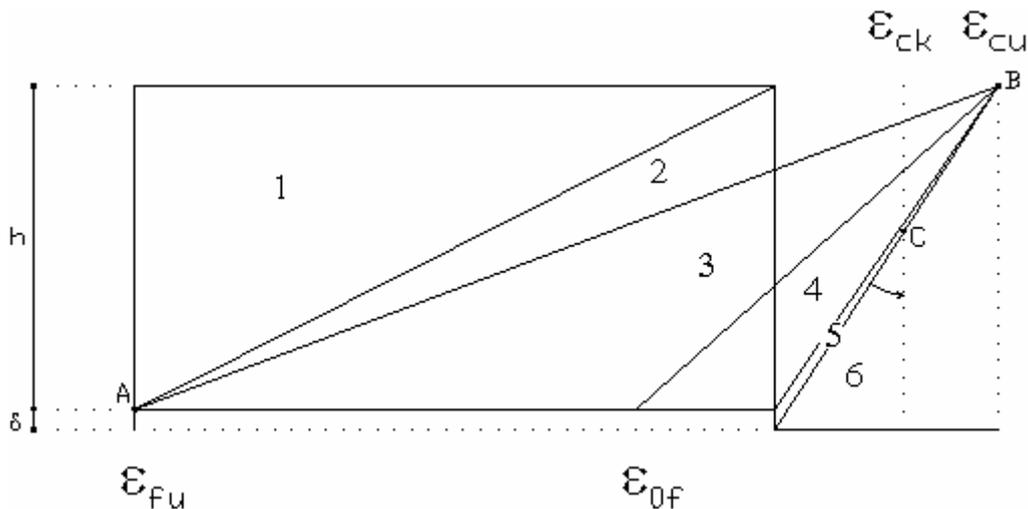
**Campo 1** : è caratterizzato dall'allungamento massimo tollerabile per l'acciaio pari a  $\epsilon_{fu}$ . Il diagramma delle deformazioni specifiche appartiene ad un fascio di rette passanti per il punto (A) mentre la distanza dall'asse neutro potrà variare da  $-\infty$  a 0.
