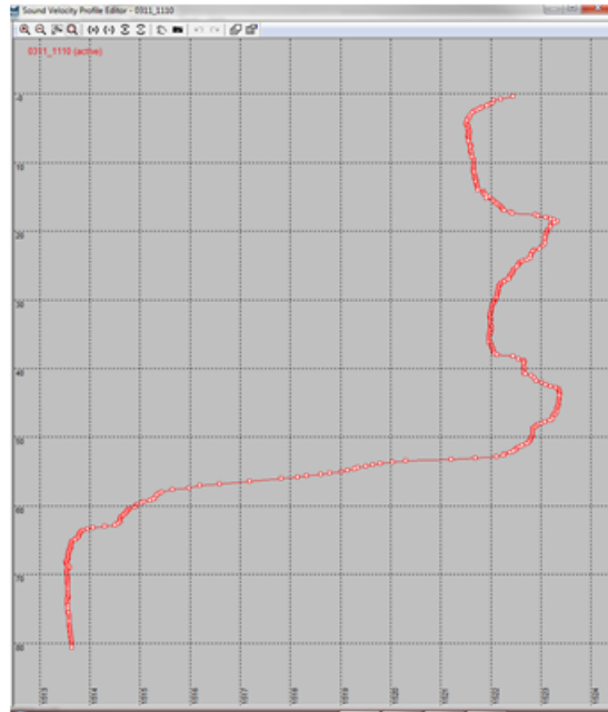
Figura 2-13: Velocità del suono acquisita in continuo mediante sonda SVS installata sulla testa del trasduttore il giorno 3/11/17.
