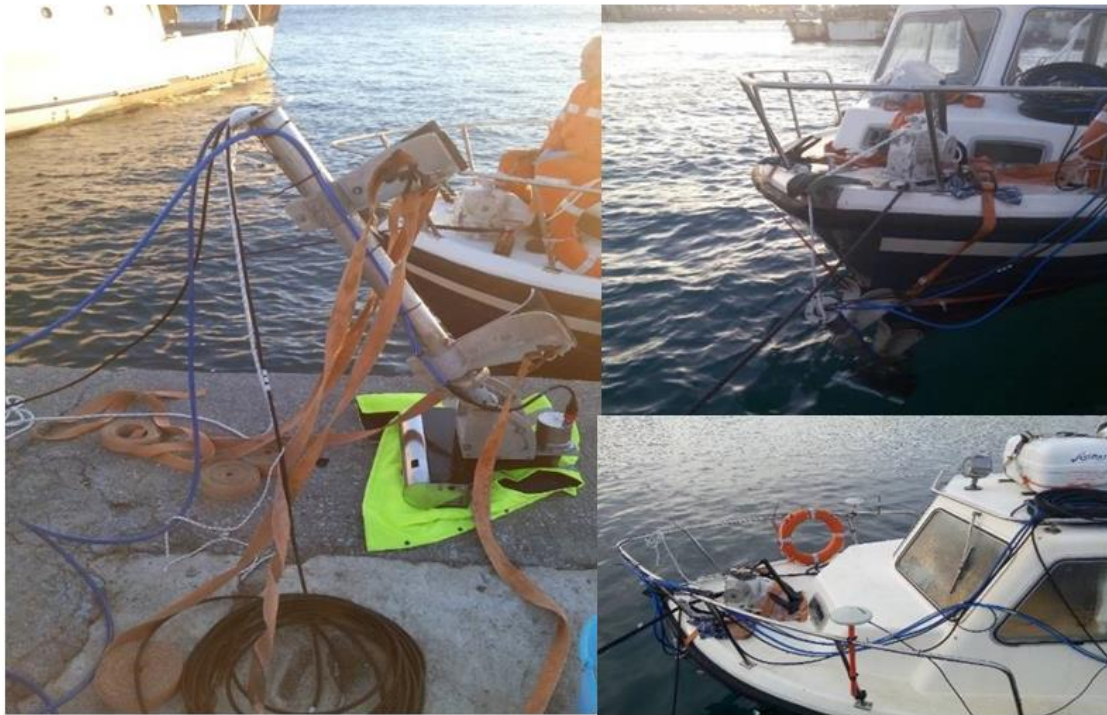
Figura 2-6: Immagini della strumentazione per il Multibeam posizionata a bordo dell'imbarcazione Zin.
