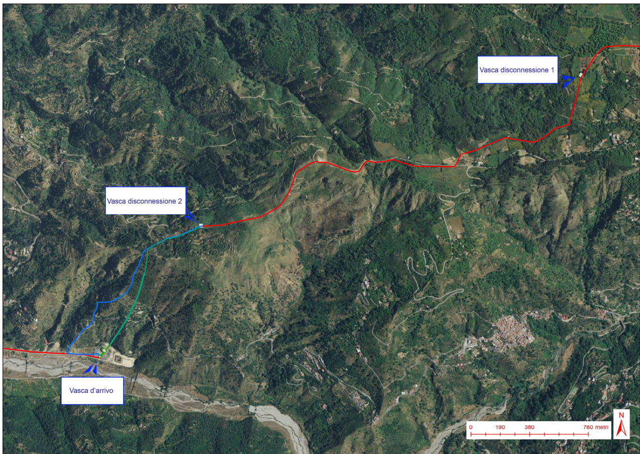
Figura 6: Tracciato della condotta (in rosso), del sistema condotta forzata-pozzo-galleria (in verde), e by-pass (in blu) con evidenza delle vasche di disconnessione su ortofoto (fonte cartografia Portale Cartografico Nazionale – Elaborazione ARCGIS 10.3.1).
