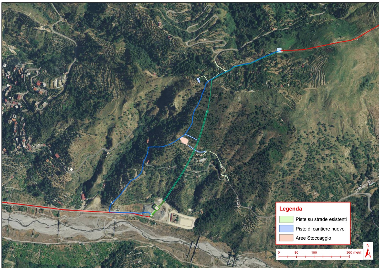
Figura 7: Piste di cantiere e aree di stoccaggio su ortofoto (fonte cartografia Portale Cartografico Nazionale - Elaborazione dati ARCGIS 10.3.1).
