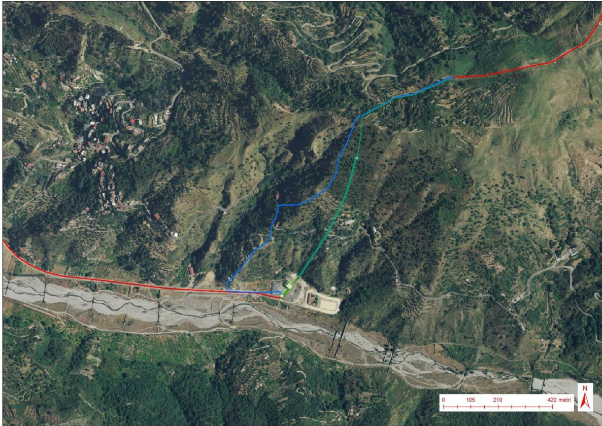
Figura 5: Tracciato della condotta (in rosso), del sistema condotta forzata-pozzo-galleria (in verde), e by-pass (in blu) su ortofoto (fonte cartografia Portale Cartografico Nazionale – Elaborazione ARCGIS 10.3.1).
