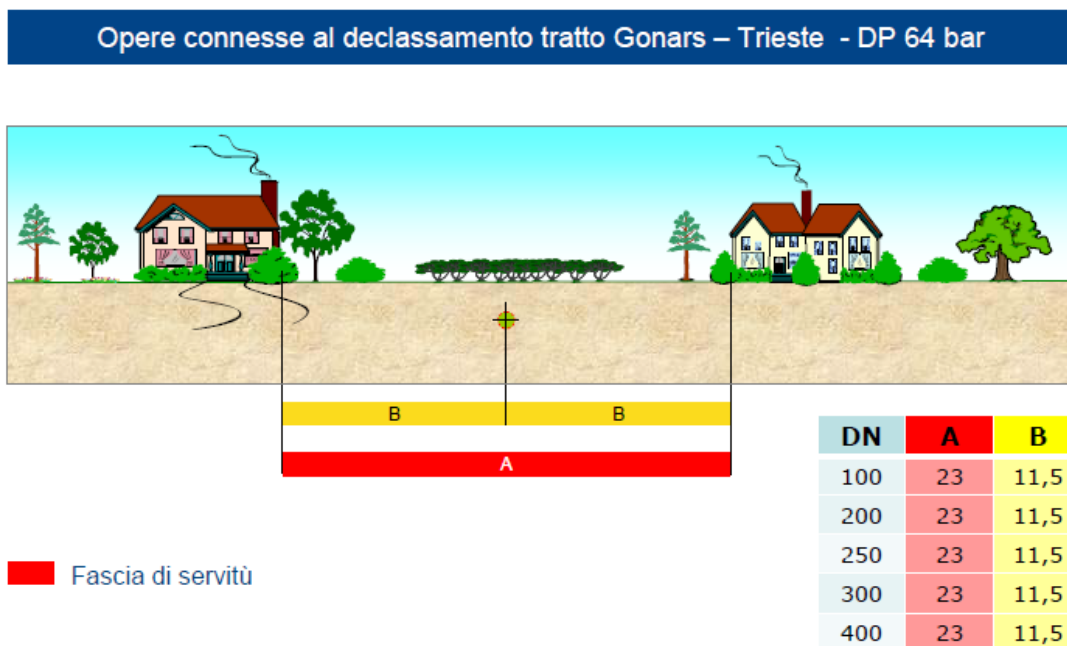
Fig. n. 3.1.2.A: Fascia di servitù DN vari – Opere connesse al declassamento del tratto Gonars – Trieste del metanodotto Mestre – Trieste DP 64 bar
