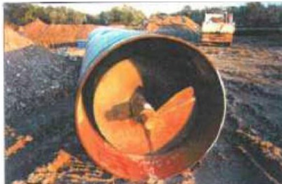
Fig. 3.1.5.9/B – Coclea per trivella spingitubo
