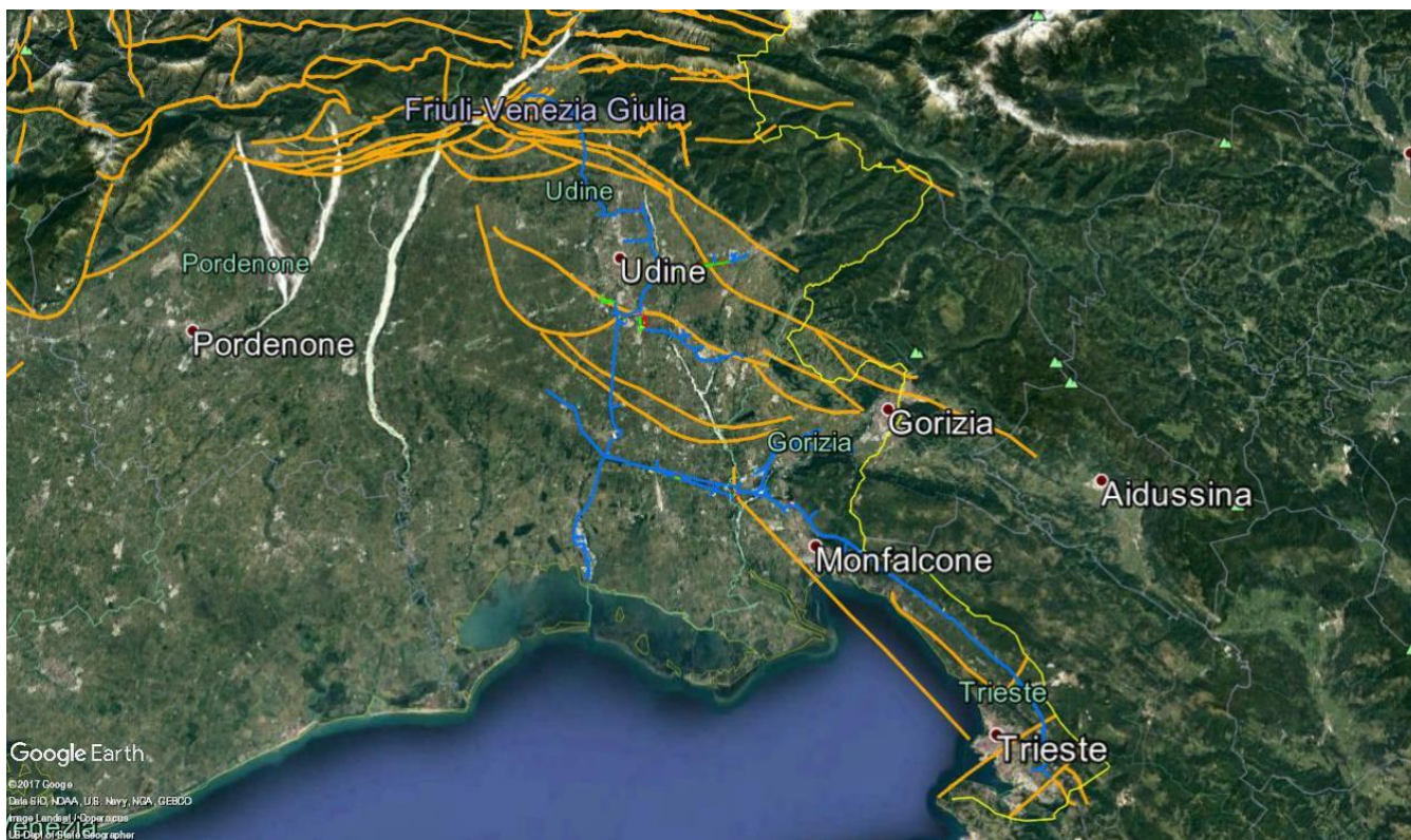
Figura 3.5.1 Visione generale delle faglie capaci (in arancione) del metanodotto in oggetto (in blu tracciato esistente, in verde tratti da dismettere, in rosso tratti in progetto)
