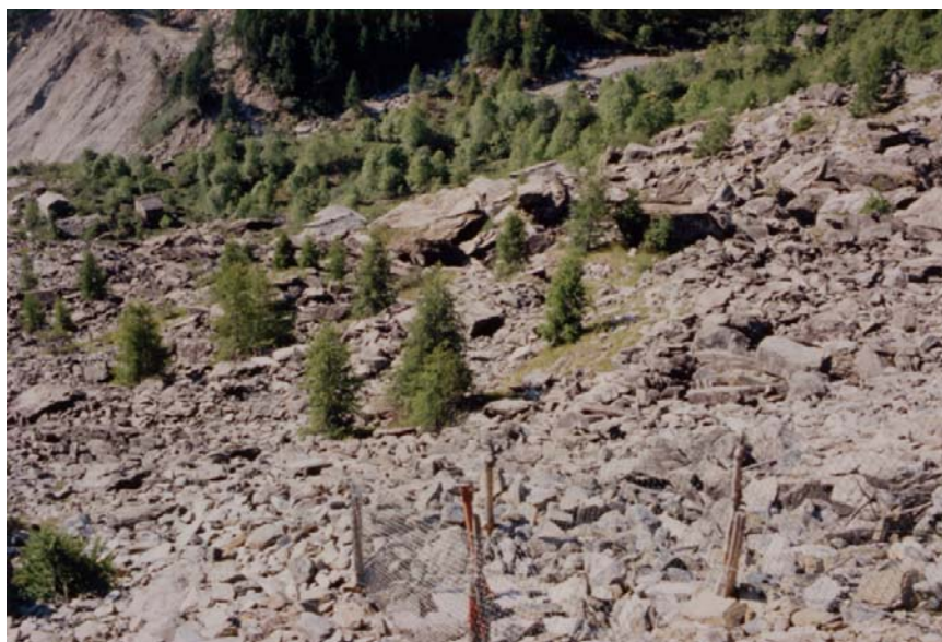
Foto 3.3: si notano le pezzature minori in primo piano (massi per muretti a secco) e le pezzature ciclopiche a distanza.
