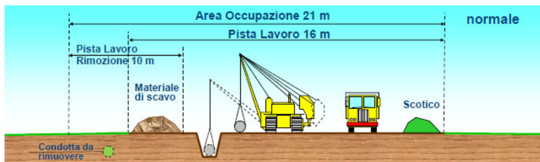
Fig. 2.3.2/C – Pista di Lavoro DN 250 / DN 300 – Metanodotto in parallelo con esistente da dismettere
