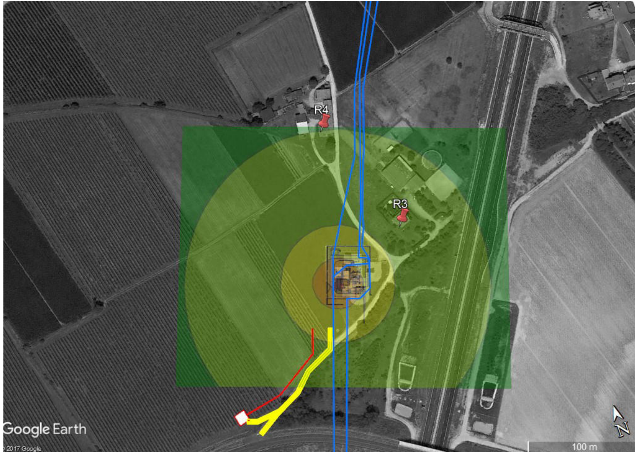
Figura 5.1.b: Dettaglio impatto acustico durante la fase di cantiere per l'impianto di Romans d'Isonzo
