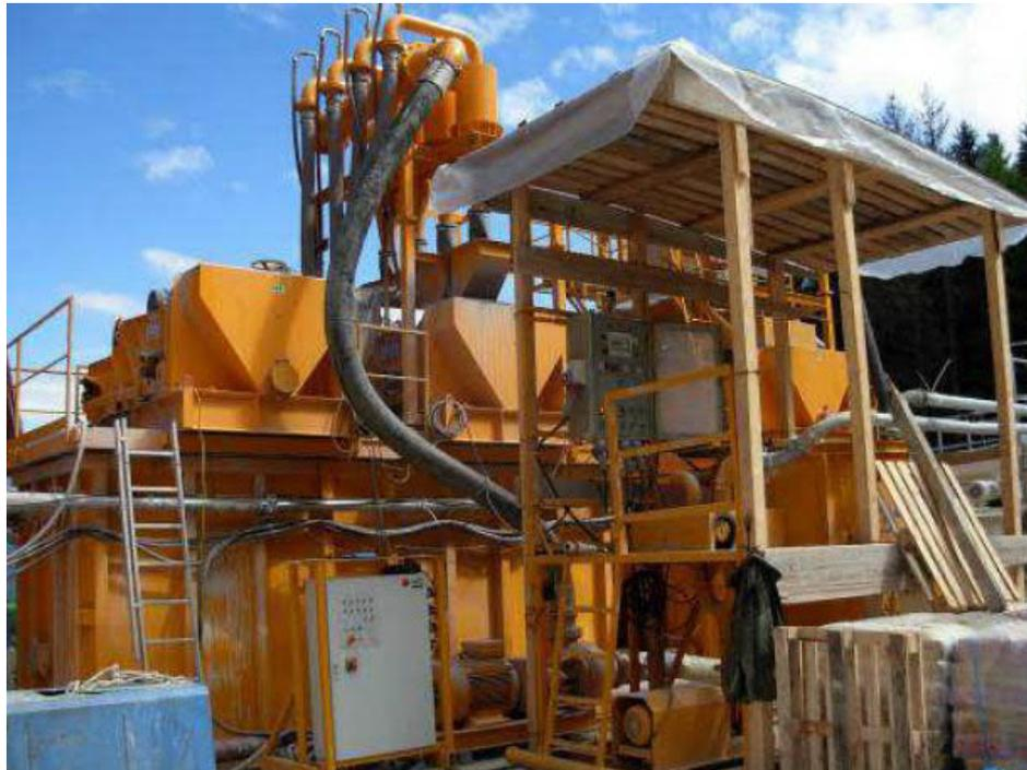
Fig. 2.2.5/S – Sistema di disidratazione
