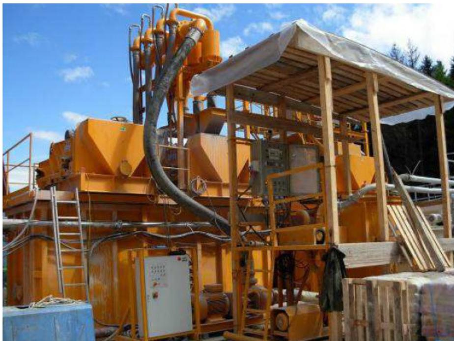
**Fig. 3.1.10/G** – Sistema di disidratazione
