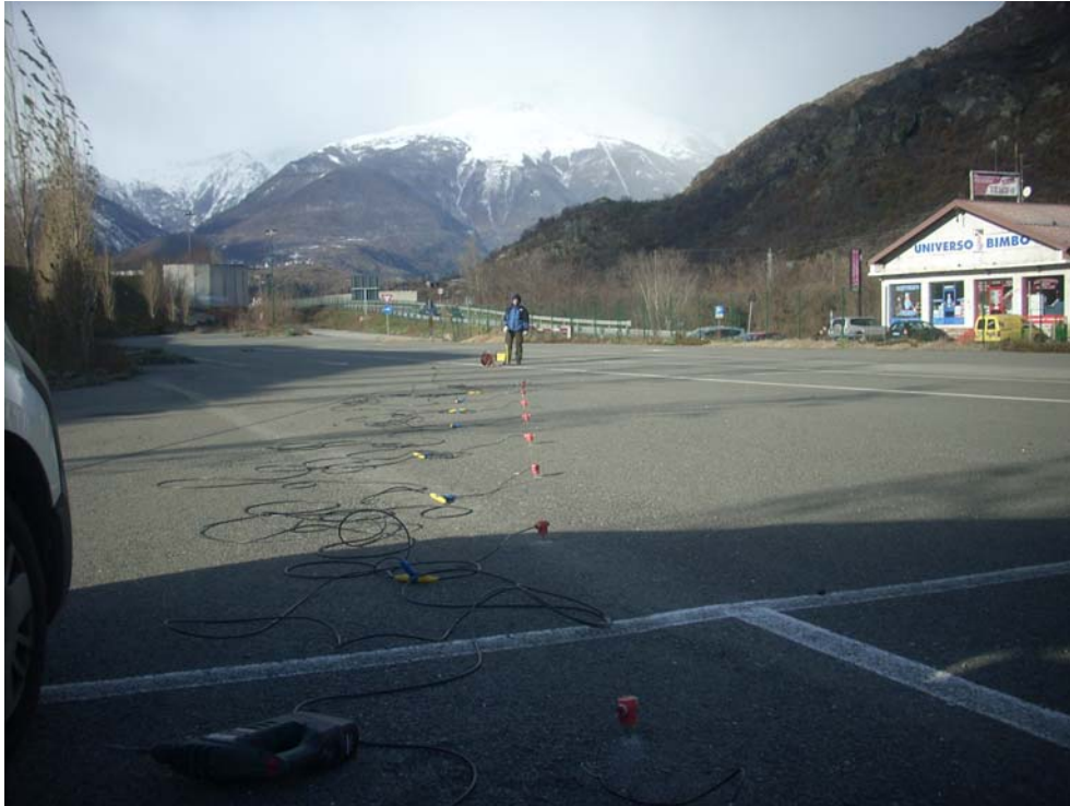
Figura 1. Stendimento di geofoni verticali
