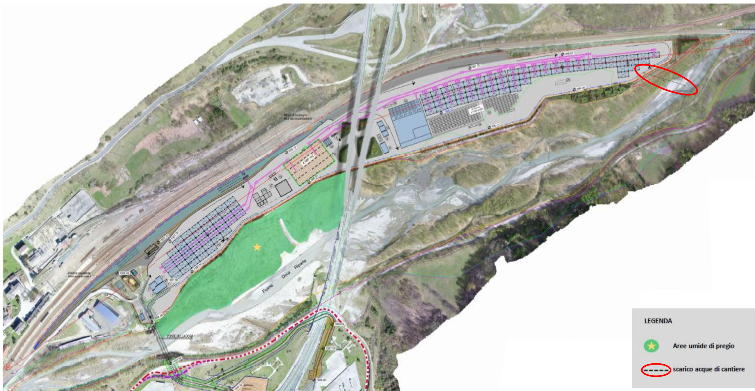
Figura 6 - Localizzazione del ponte in progetto, degli habitat di pregio presenti (in verde) e dello scarico delle acque di cantiere
