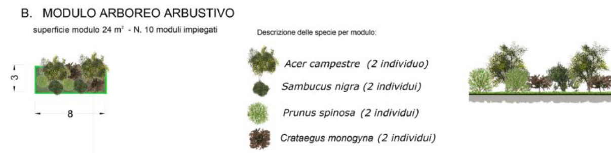
Figura 12 – Composizione e struttura della siepe mista prevista a nord del vallo paramassi (estratto PRV_LOM_C3C_7325: Album tipologico mitigazioni a verde delle aree oggetto di variante)
