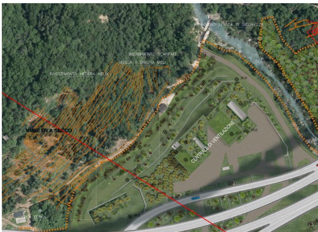
Figura 11 – Stralcio relativo alla sistemazione finale del cantiere di Maddalena a ovest del Clarea, zona a nord del viadotto autostradale (estratto PRV_LOM_C3C_6834: Planimetria di riferimento delle sezioni paesaggistiche e degli interventi di ripristino finale cantiere -Cantiere di Maddalena)
