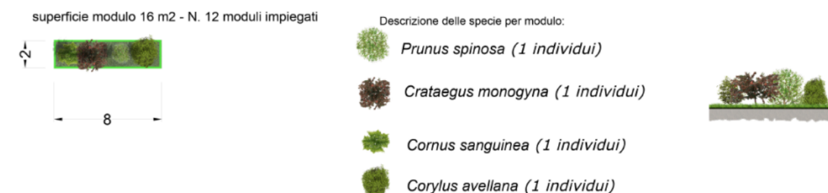
Figura 23 – Composizione e struttura del modulo arbustivo destinato alla creazione di siepi (estratto PRV_LOM_C3C_7325: Album tipologico mitigazioni a verde delle aree oggetto di variante)
