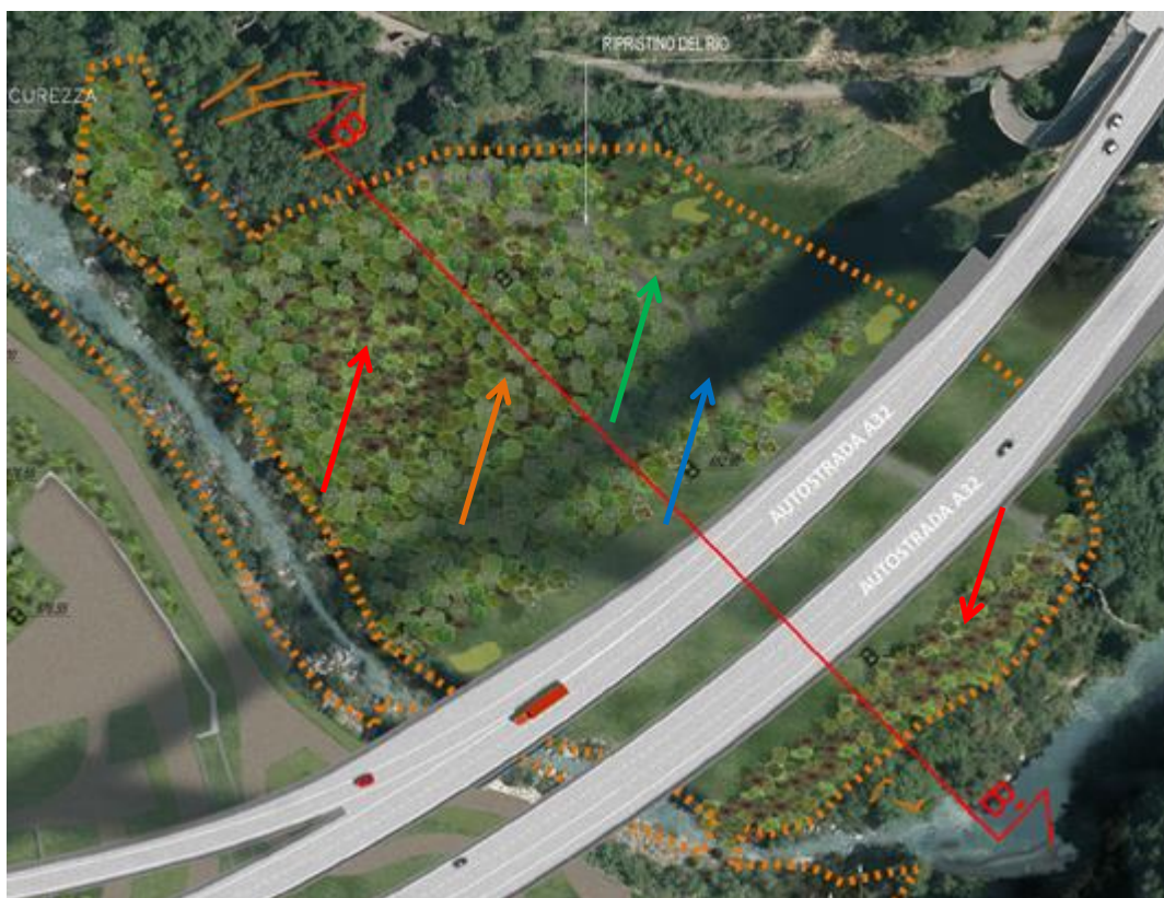
Figura 25 – Particolare del ripristino previsto: tracciato ipotetico del rio, le cui acque torneranno a scorrere sul versante, a ripristino effettuato (freccia azzurra); moduli arboreo-arbustivi (freccia arancione); siepi arbustive (freccia verde); moduli arbustivi (freccia rossa. In verde chiaro le aree nelle quali è previsto il trapianto di specie di aristolochia (estratto PRV_LOM_C3C_6834: Planimetria di riferimento delle sezioni paesaggistiche e degli interventi di ripristino finale cantiere -Cantiere di Maddalena)
