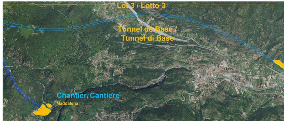
Si tratta del lotto finalizzato alla realizzazione dello scavo del Tunnel di Base dal cantiere di Maddalena a Chiomonte. Comprende lo scavo dei due tubi del Tunnel di Base tra l'area di sicurezza di Clarea e l'imbocco est a Susa.
