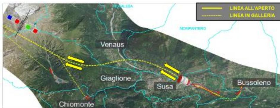
Figura 9 – Configurazione dello scavo da Susa (progetto definitivo approvato)
