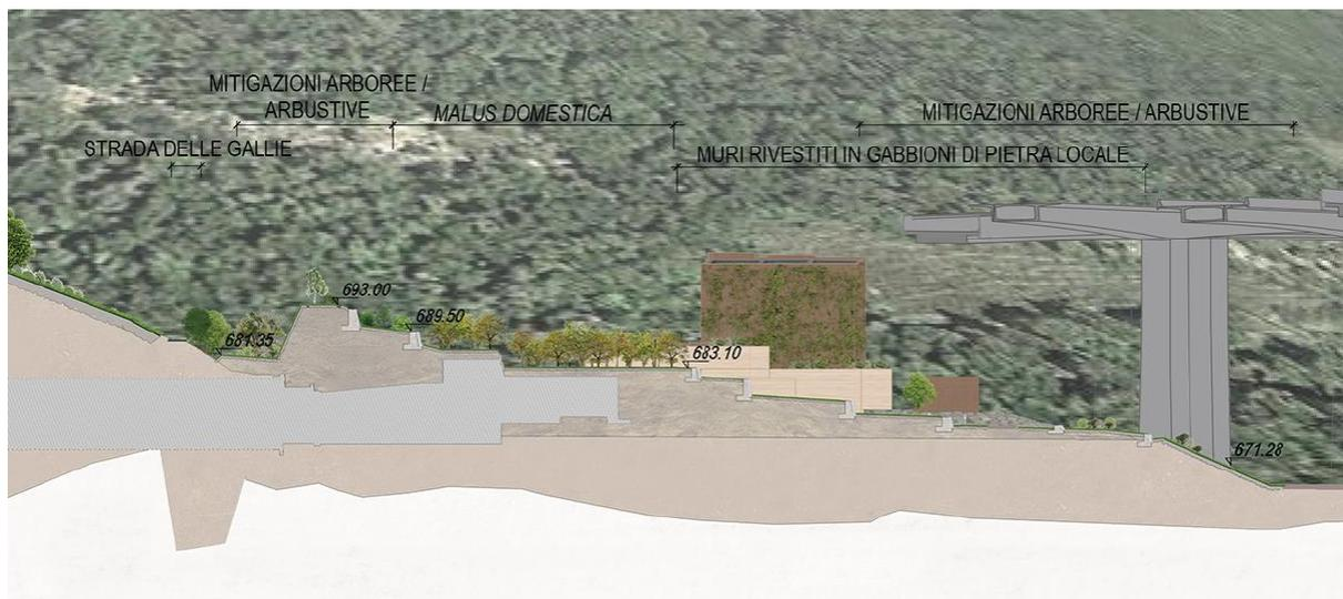
*Figura 82 –Area di Maddalena - Sezioni paesaggistiche in fase di esercizio: mitigazione vallo paramassi*
