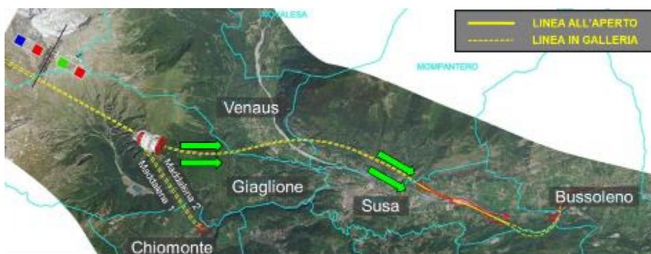
Figura 10 – Configurazione dello scavo da Chiomonte (variante sicurezza)
