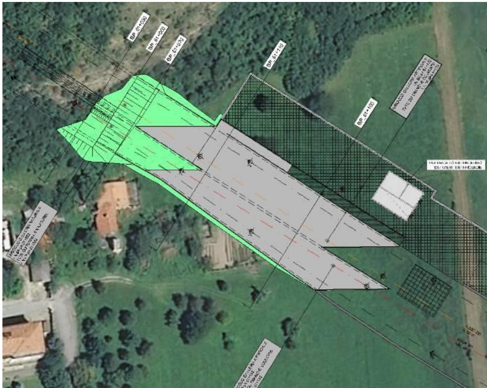
Ortofoto planimetria di imbocco – Sistemazione finale
