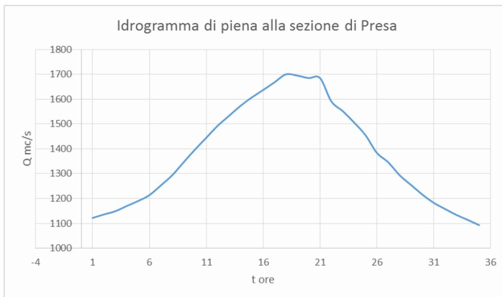
FIGURA 2.3 IDROGRAMMA DI PIENA CON T=200 ANNI ALLA SEZIONE DI PRESA DELLA TRAVERSA EX CIMA, UTILIZZATO COME INPUT DI CALCOLO PER L'ANALISI DEL DEFLUSSO NELLE AREE GOLENALI
