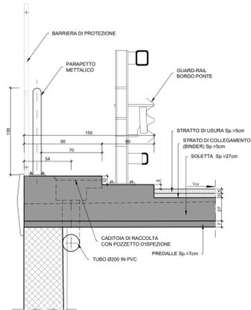
SEZIONE STRADALE TIPO IN VIADOTTO
