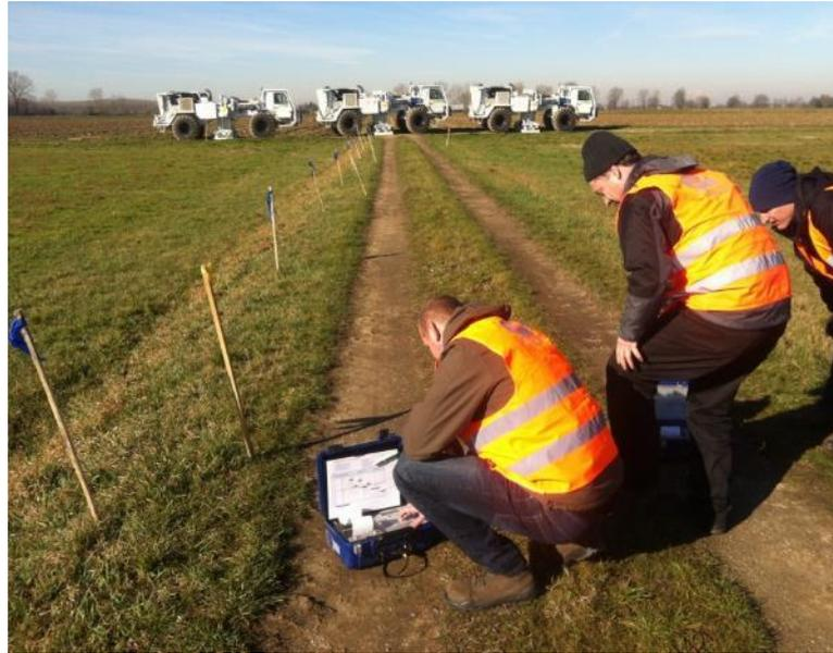
*Figura 21: Misurazioni della PPV*
