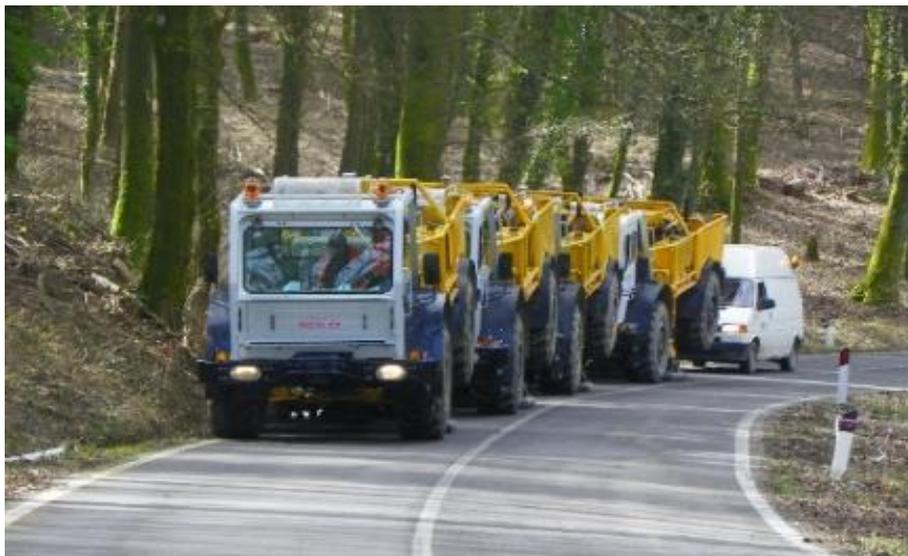
*Figura 13: Esempio di operazioni vibroseis*
