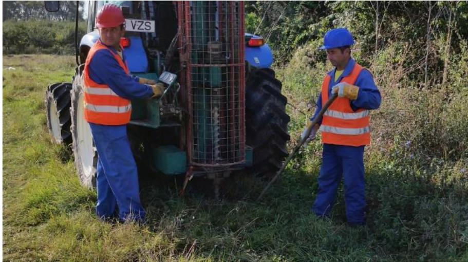
*Figura 19: Esempi di strutture di perforazione montati su un trattore.*
