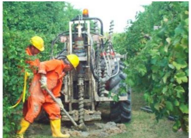
*Figura 20: Esempi di trivelle montate su mini-trattori*
