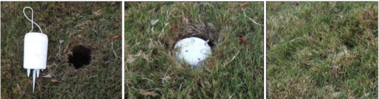
*Figura 25: Esempio di impiego di geofono in sedimenti sciolti o suolo morbido. Sulla sinistra: un buco di 15 cm di diametro scavato ad una profondità di 25 cm. Al centro: il geofono è posizionato verticalmente nel buco a livello della superficie. Il suolo viene reimmesso intorno al geofono. Sulla destra la cima del geofono viene coperta con l'erba.*
