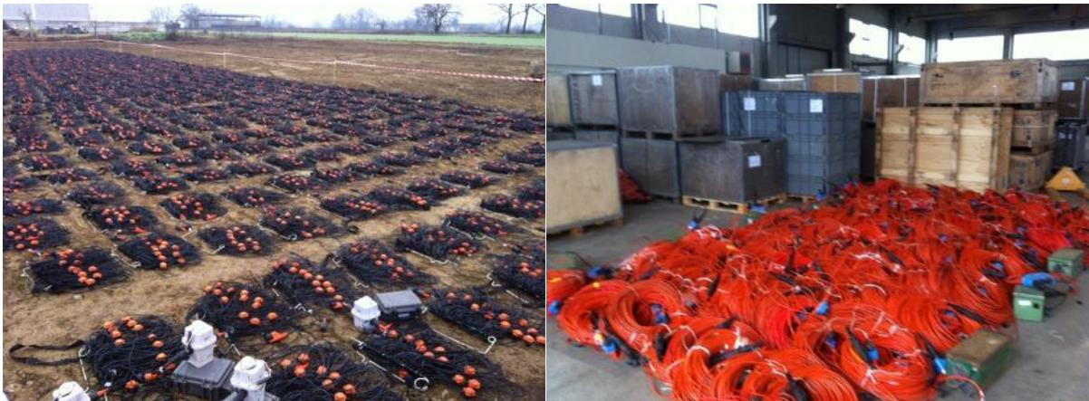
*Figura 15: Geofoni e cavi pronti per essere utilizzati*
