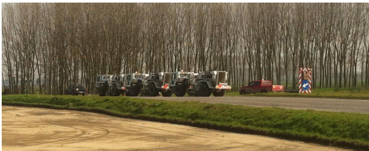
Figura 14: Esempi di operazioni vibroseis in zone rurali
