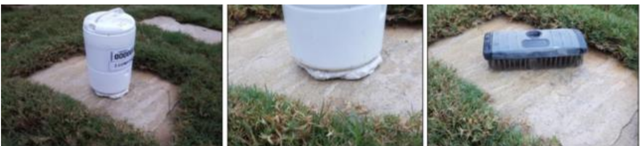
Figura 26: Esempio di impiego del geofono su roccia. Sulla sinistra il geofono senza la punta viene fissato sulla roccia con dell'intonaco. Al centro: il geofono è posizionato verticalmente utilizzando lo stucco(zoom)/superficie rocciosa. Sulla destra: il geofono e lo stucco vengono rimossi, la superficie rocciosa viene ripulita con acqua e spazzole.
