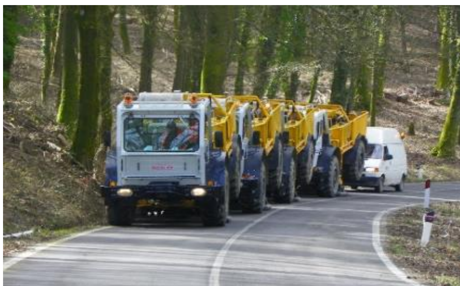
Figura 13: Esempio di operazioni vibroseis
