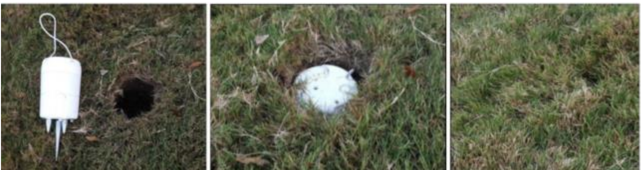
Figura 25: Esempio di impiego di geofono in sedimenti sciolti o suolo morbido. Sulla sinistra: un buco di 15 cm di diametro scavato ad una profondità di 25 cm. Al centro: il geofono è posizionato verticalmente nel buco a livello della superficie. Il suolo viene reimmesso intorno al geofono. Sulla destra la cima del geofono viene coperta con l'erba.
