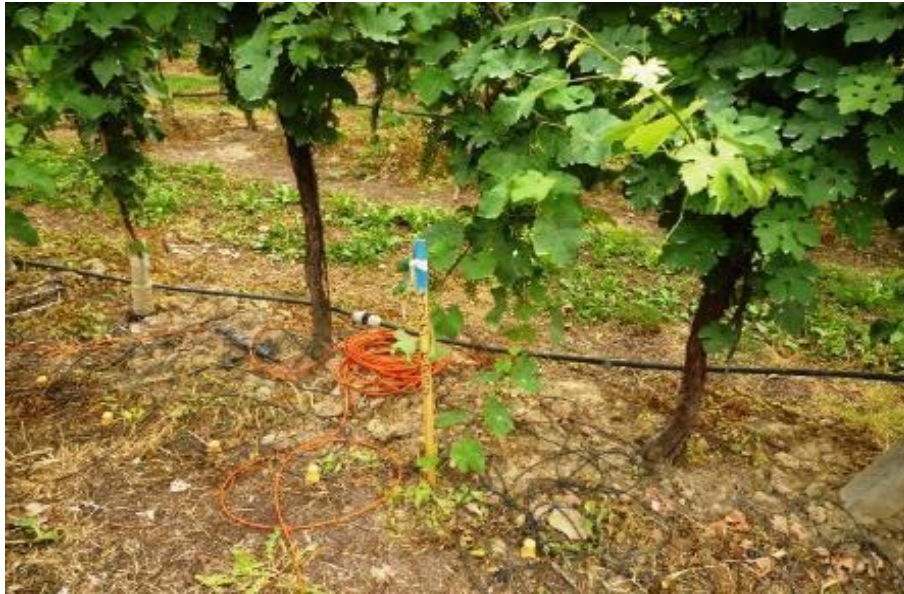
Figura 17: Geofoni utilizzati in contesto rurale
