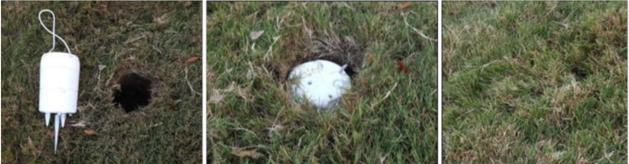
Figura 20: Esempio di impiego di geofono in sedimenti sciolti o suolo morbido. Sulla sinistra: un buco di 15 cm di diametro scavato ad una profondità di 25 cm. Al centro: il geofono è posizionato verticalmente nel buco a livello della superficie. Il suolo viene reimmesso intorno al geofono. Sulla destra: il tetto del geofono viene coperto con l'erba.
