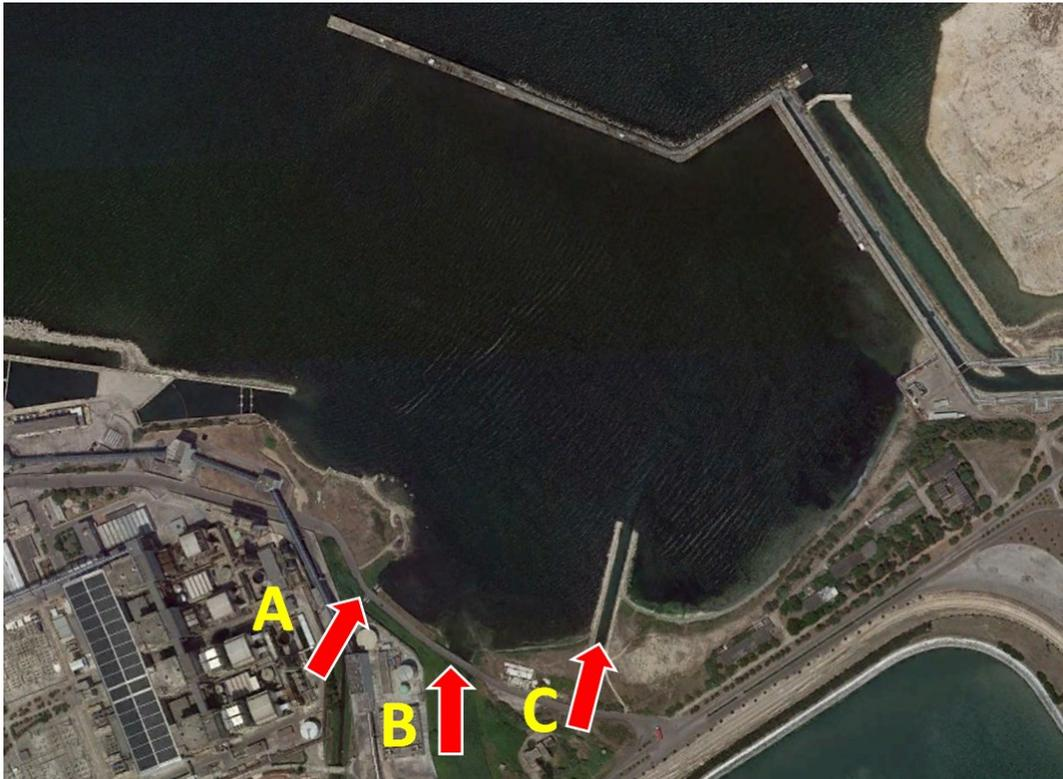
**figura 3.8 - Localizzazione canali di scarico - situazione attuale**
