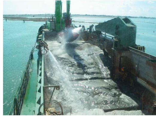
Figura 3.1-3 Water jet in azione
