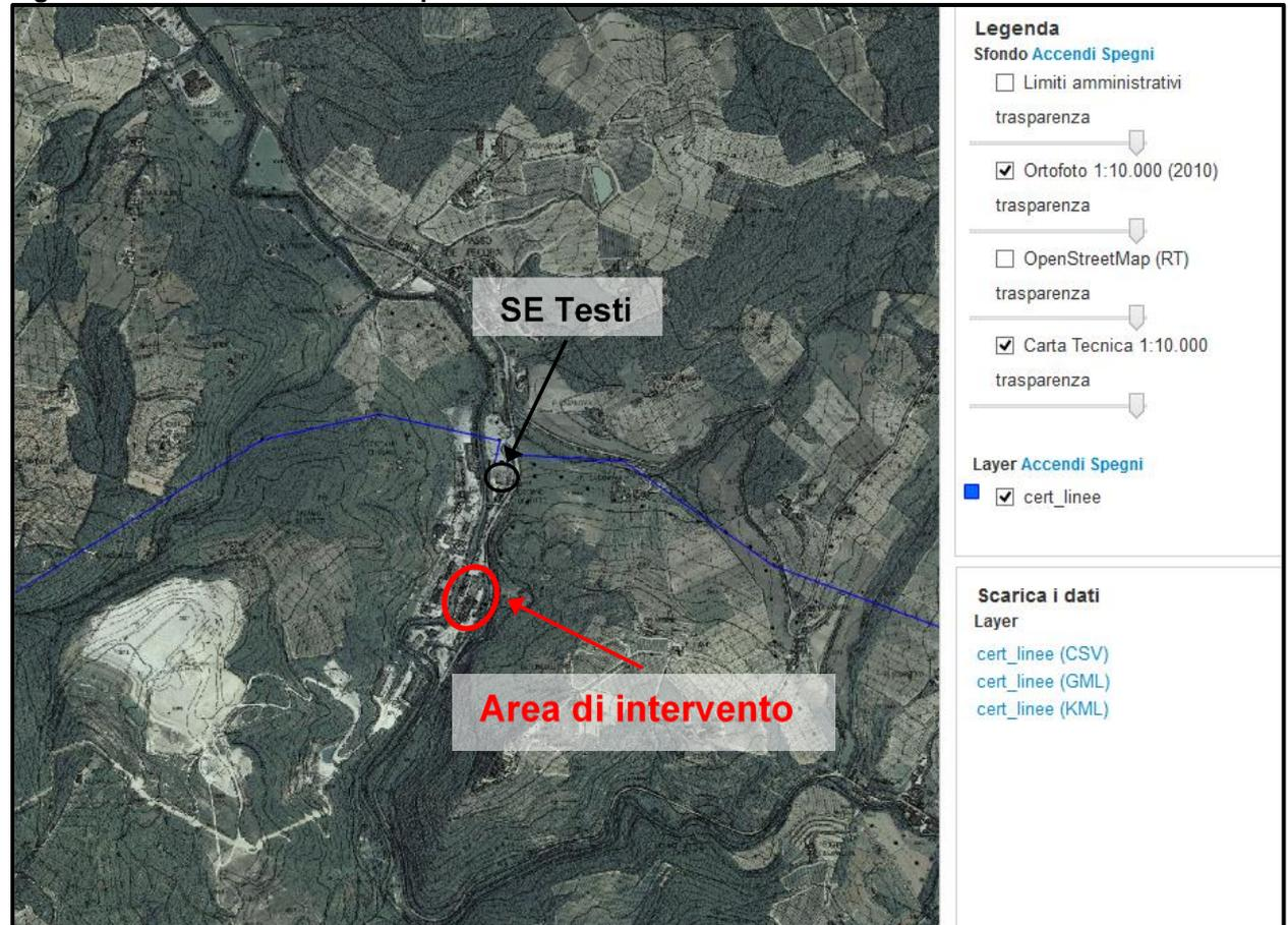
Come mostrato in figura, nell'area di studio sono presenti due linee elettriche aeree a 132 kV (di proprietà Terna S.p.A.) in entrata nella Stazione Elettrica denominata "Testi", localizzata a circa 350 m a nord dell'area di progetto; in particolare la linea che si sviluppa verso est rispetto alla SE è denominata "Figline – Testi", mentre quella che si sviluppa verso ovest è la "Bargino - Testi".
