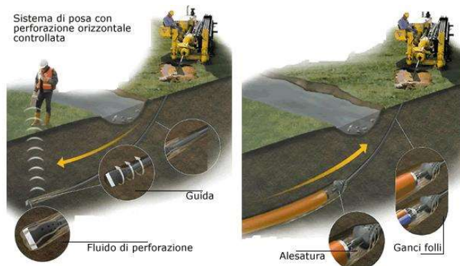
Fig. 1.8 – Posa in opera tubazione per alloggiare cavi
