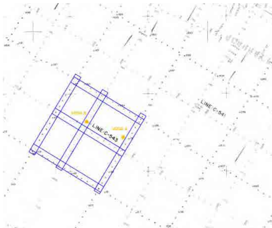
Figura 4-12: Tratti di Sezioni sismiche del Progetto Videpi passanti dal Campo Vega
