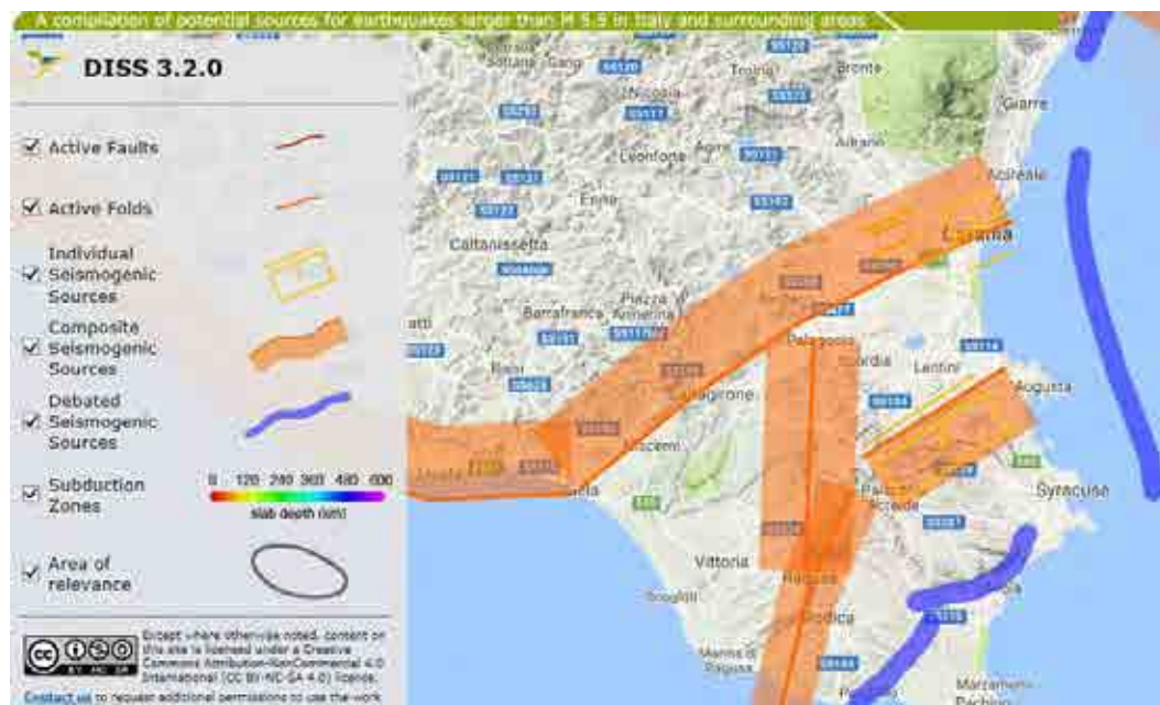
Figura 4-5: Faglie Attive e Strutture Sismogenetiche della Sicilia Sud-Orientale (INGV, 2015)
