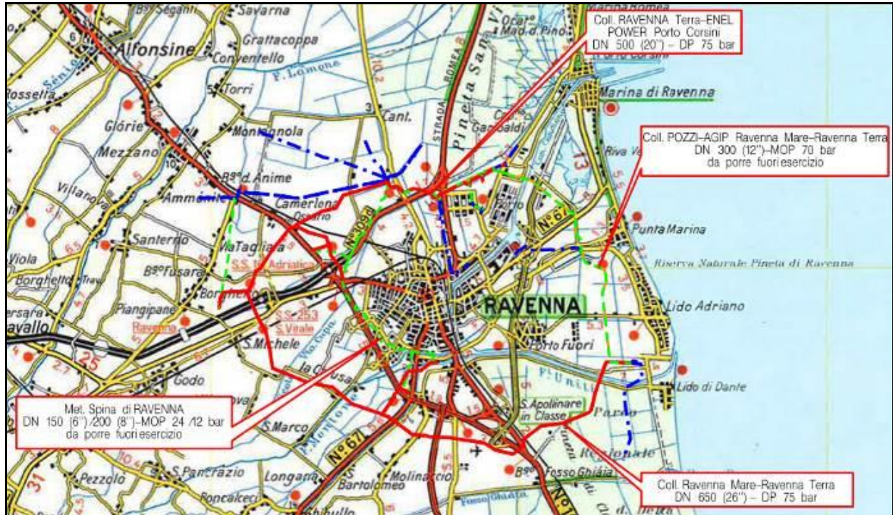
Fig. 2/A – Inquadramento generale delle opere in progetto (in rosso), in dismissione (verde) ed esistenti (in blu)
