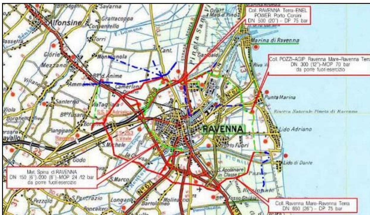
Figura 2.1/A – Stralcio Atlante 1:200.000 con localizzazione delle aree di intervento (in rosso met. In progetto, in verde met. In dismissione, in blu met. esistenti)
