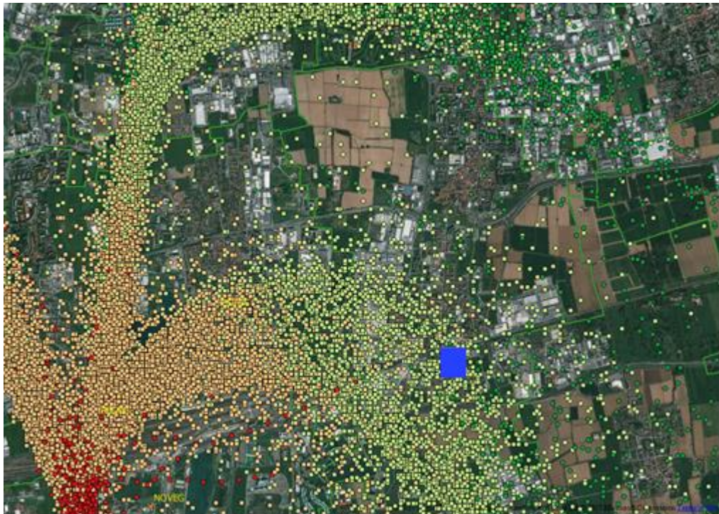
Figura 6-1 Quote tracciati radar (rosso 0-500 m, arancio 500-1000 m, verde oltre) - area centralina di Linate nel riquadro blu
